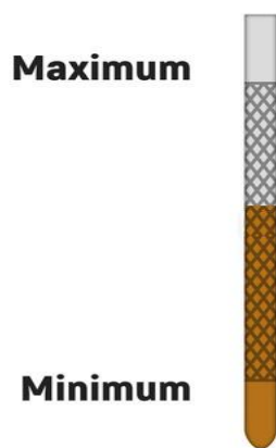
Abb.: Der korrekte Motor-Ölstand gemessen mit einem Ölmessstab
